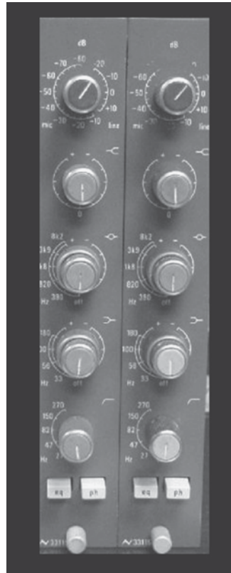
Figure 3.1 Neve 33115 module (like a 1071).
